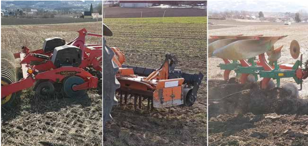
Bilde 2. Jordarbeidingen ble gjennomført med Väderstad Carrier (til venstre), Ferraboli horisontal rotorharv (i midten) eller 3 skjærs vendeplog. Foto: Till Seehusen.
