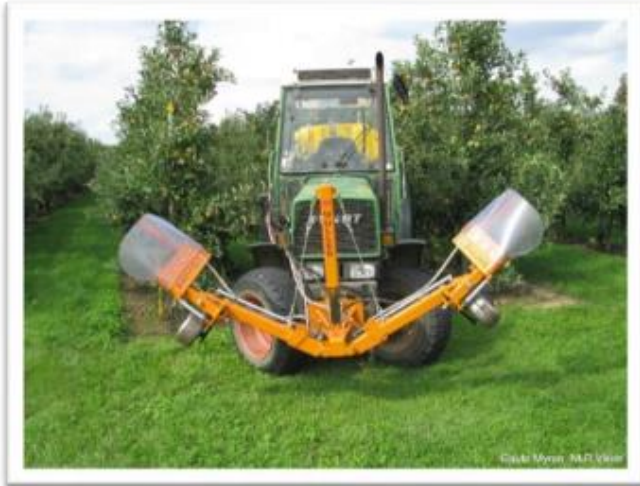
Bilde 1 og 3: viser sprøyteutstyr ved forsøksstasjonen Randwijk i Nederland. Det er brukt to lavavdriftsdyser som skal redusere faren for skade på frukttræa.
