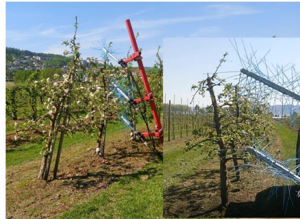
Bilde 2: Baum tynningsmaskin som piskar bort blomane. Innstilling og rett bruk er nødvendig for å få eit tilfredstillande resultat. Maskina tynnte hardt i tretoppene og forsiktig inni trea.
