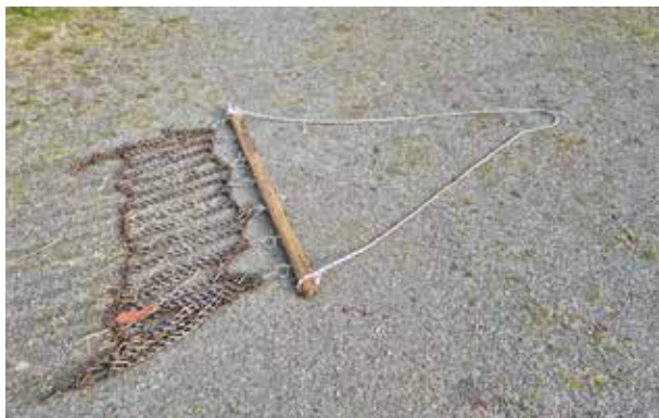
Enkelt: En gammel og oppbrukt traktorkjetting får nytt liv som ugrasbekjempingsredskap. / FOTO: Kari Bysveen
