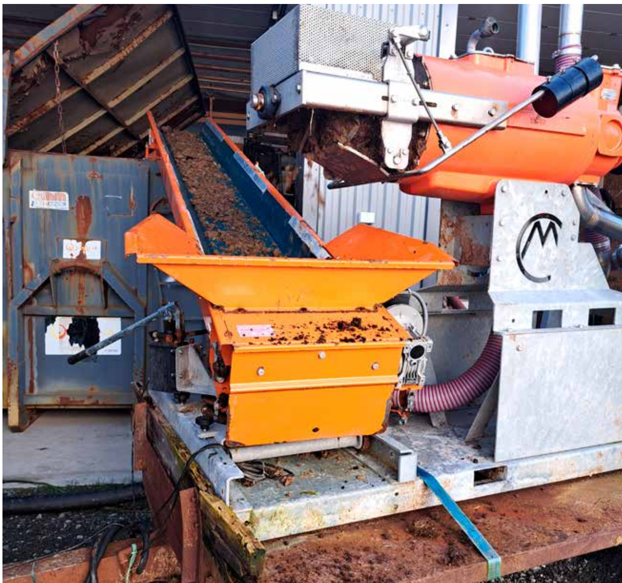
Separering: Separering av biorest med skrupresseseparator kan redusere behovet for spreieareal. Cri-man separator fungerte godt i forsøk. / FOTO: Jon Geirmund Lied
