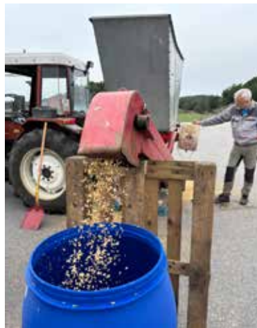
Krossing: Valset korn tilsatt konserveringsmiddel på veg ut av krossmaskina. Vanninnholdet må være over 30 % for at valsing i krosser skal gå greit. /FOTO: Erlend Vandeskog
