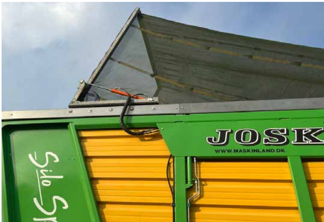
Nett: Detalj heiv/senkbart nett, TopCover frå danske Siwi maskiner. /FOTO: Siwi maskiner
