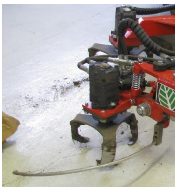
Bilete 8 og 9. Rotorharv blir drive av oljetrykk. Horisontal aksling på biletet under og vertikal aksling på biletet over.
