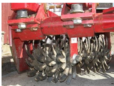
Bilete 10 og 11. Skålharv drive av oljetrykk med glatt overflate på øvste biletet. Friksjonsdrevne stjerneforma akslingar på nedste biletet.
