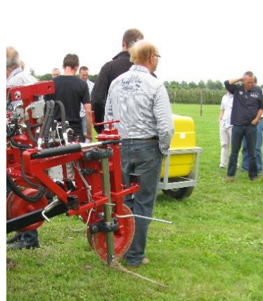
Bilete 12 og 13. Ugraskniv med utløysar. Resultat av eit par køyringar på biletet nedst.
