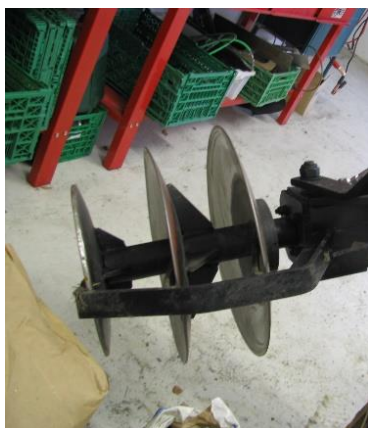
Bilete 10 og 11. Skålharv drive av oljetrykk med glatt overflate på øvste biletet. Friksjonsdrevne stjerneforma akslingar på nedste biletet.
