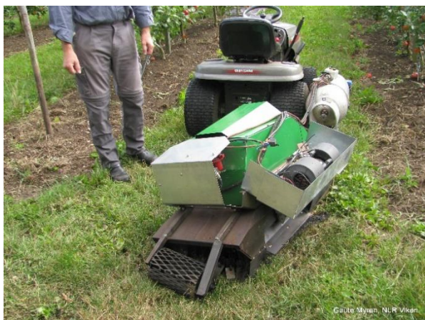
Bilete 20. ENVO-DAN i Danmark har laga prototype av propanbrennar som kan festast til ein ATV.
