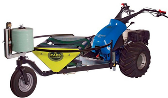
Figur 12 «CAEB» rundballepakter. Dimensjonen av pakkebordet tilsvarer dimensjonen av baller presset med «CAEB» minipresse
