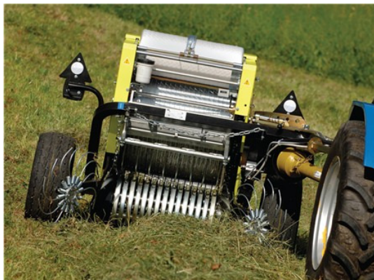
Figur11 "CAEB" presse med sideflyttbart drag
