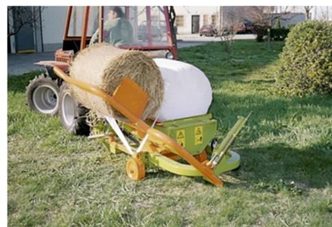
Figur 13 Løftearm på «Wolagri» pakkeren letter arbeidsoperasjonen
