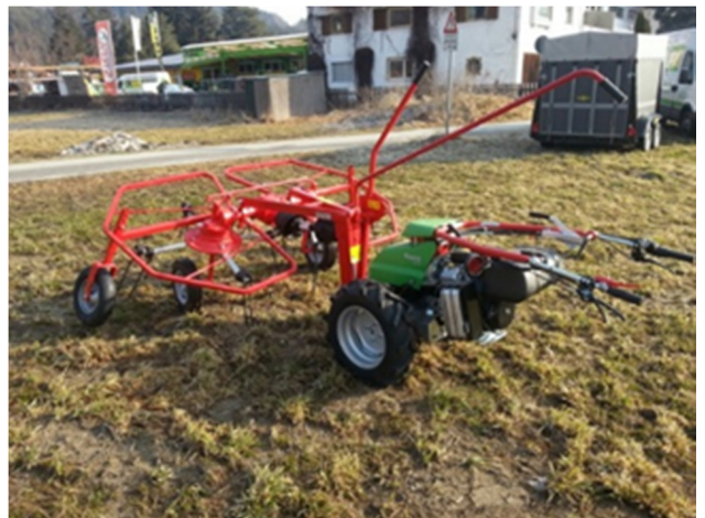
Figur 8 «Molon» to – rotors sprederive til høylaging
