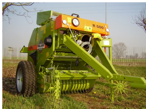
Figur 12 «Wolagri» minipresse på slep med skårsamler
