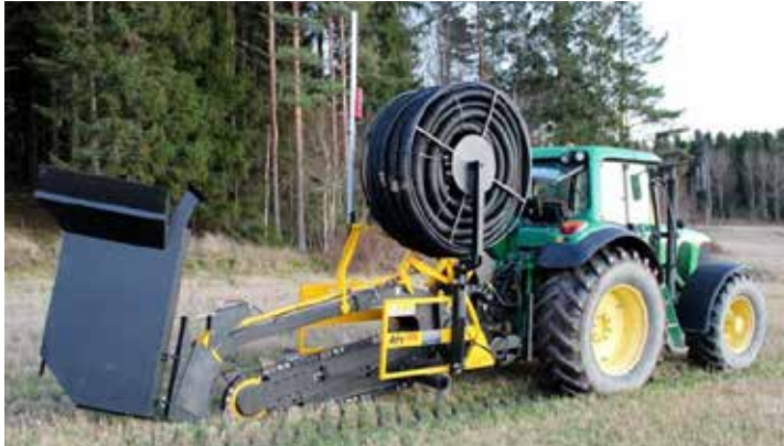
Kjedegraver med drenssslange på trommel og drenskasse bak
