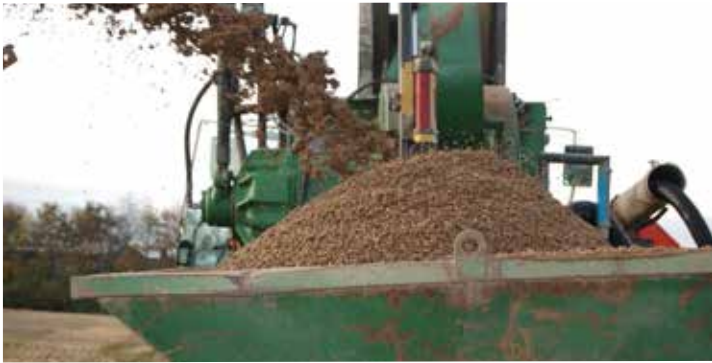
Drenskassa fylt med singel. Legg merke til laserutstyr.
