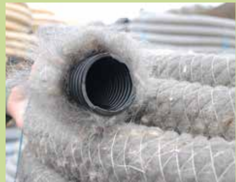
Rør med ferdig filter.
