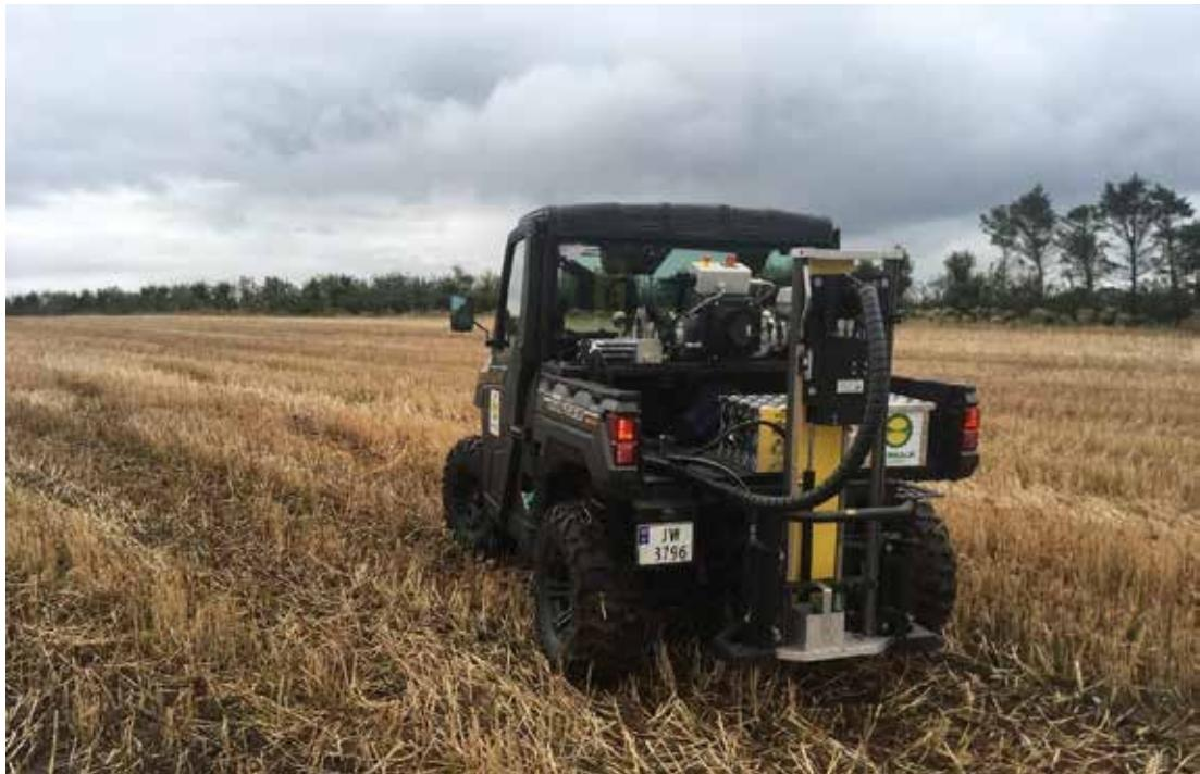
Nytt for året er uttak av jordprøver med RTV festa jordbor for presisjonskalkning. Foto. Odd Ingebret Paulsen
