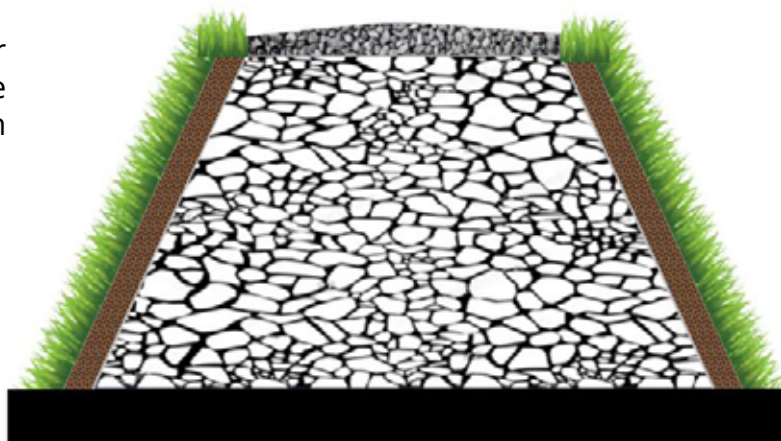
Prinsippskisse flomvoll. En kjerne av stein/tunge masser som plastres med jord og såes til med gras.
