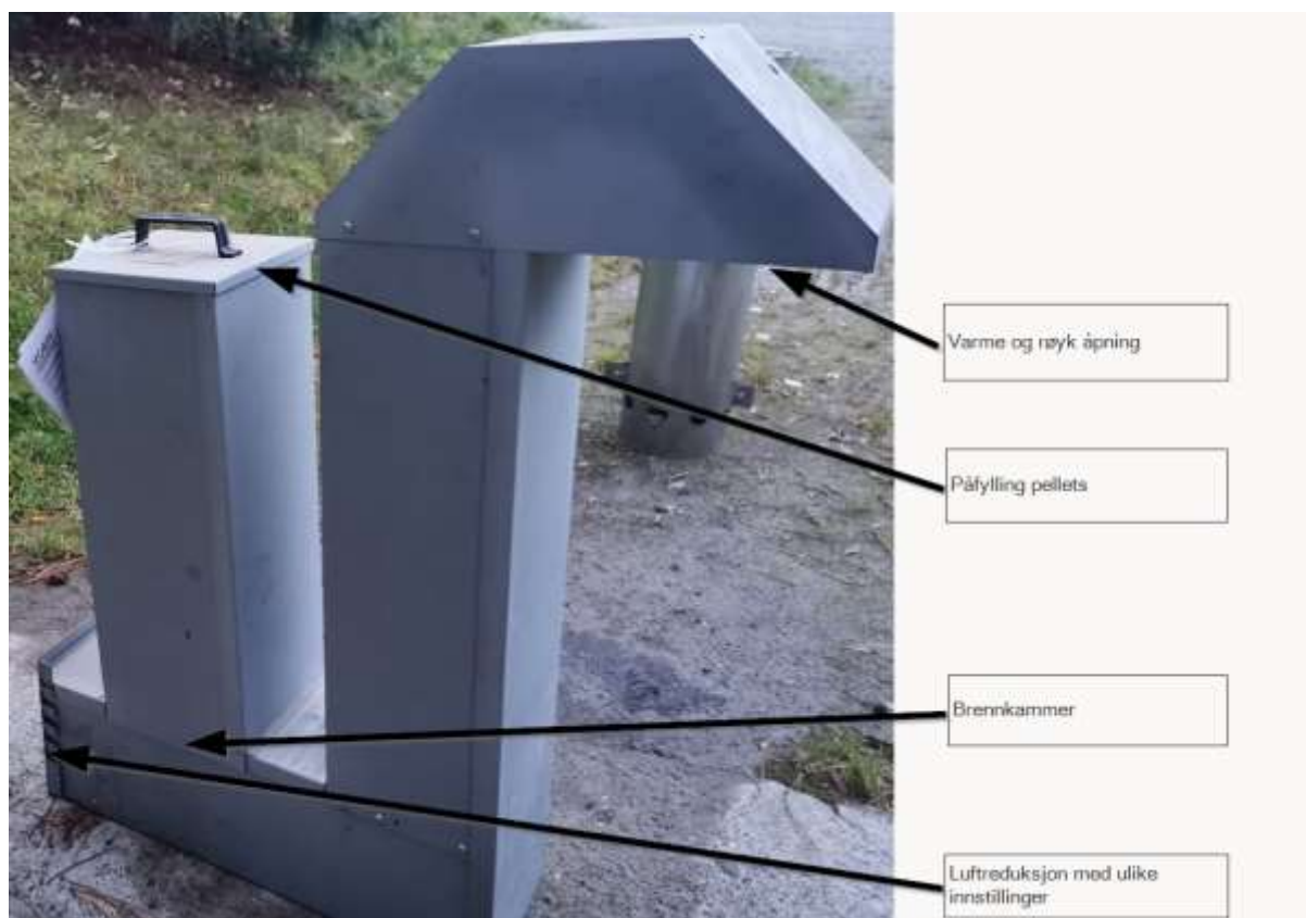
Bilete 1: Vöen antifrost ovn som er berekna på trepellets.
