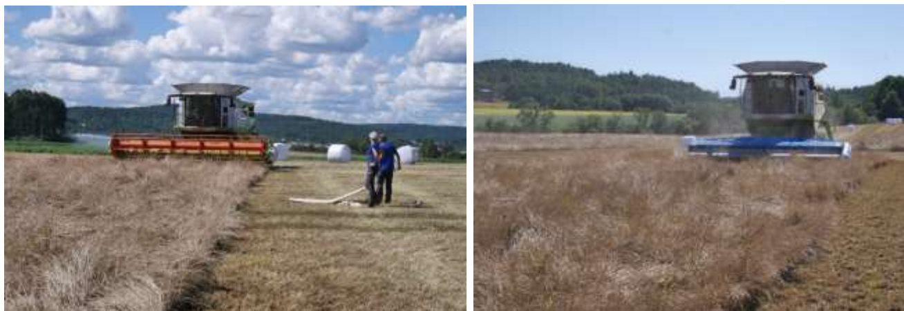
Bilde 1: Kjøring med konvensjonelt skjærebord (til venstre) og ribbeskjærebordet (til høyre) i frøeng av flerårig raigras 'Figgjo'. I bildet til venstre står personale fra NLR Viken klar med oppfangerplata for å bestemme frøspill over sålda.
