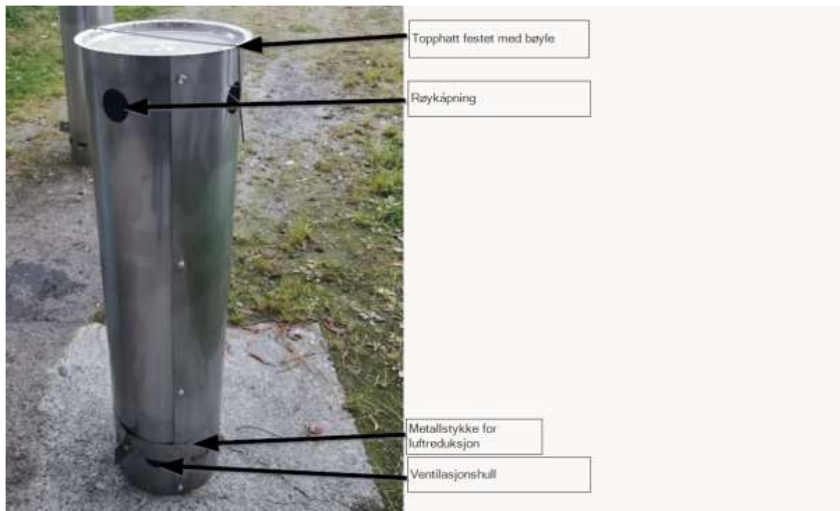
Bilete 3: FS-Wiesel ovn berekna på trebrikettar eller ved.
