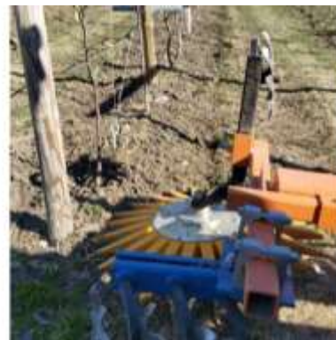
Mekanisk freser er tilpasset fruktfeltet. Arbeidsbredden er 50 cm. Dyrker sitt utstyr. Foto: Anstein Freberg
