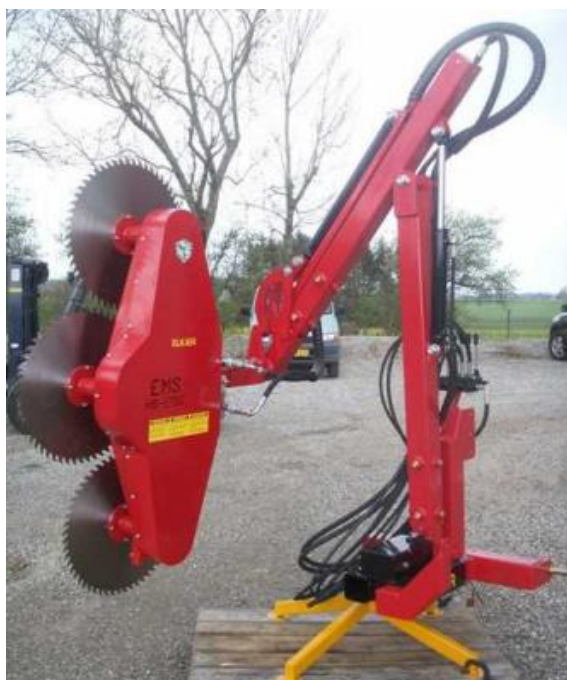
Figur 7. Bilete frå https://www.elkaer-maskiner.dk Sagblad kan ta grove greiner opptil 25 cm.
