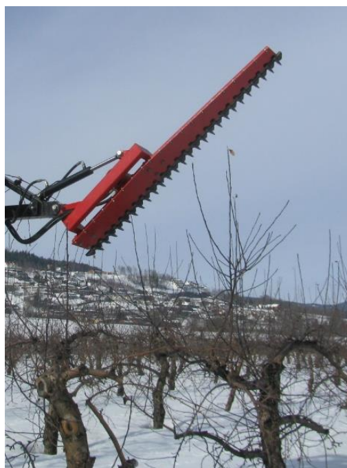
Figur 8. Elkær fingerbjelke i bruk i epletre i Lier. Fingerbjelke kan ta greiner opptil 5 cm i diameter. Foto: Gaute Myren, NLR Viken.
