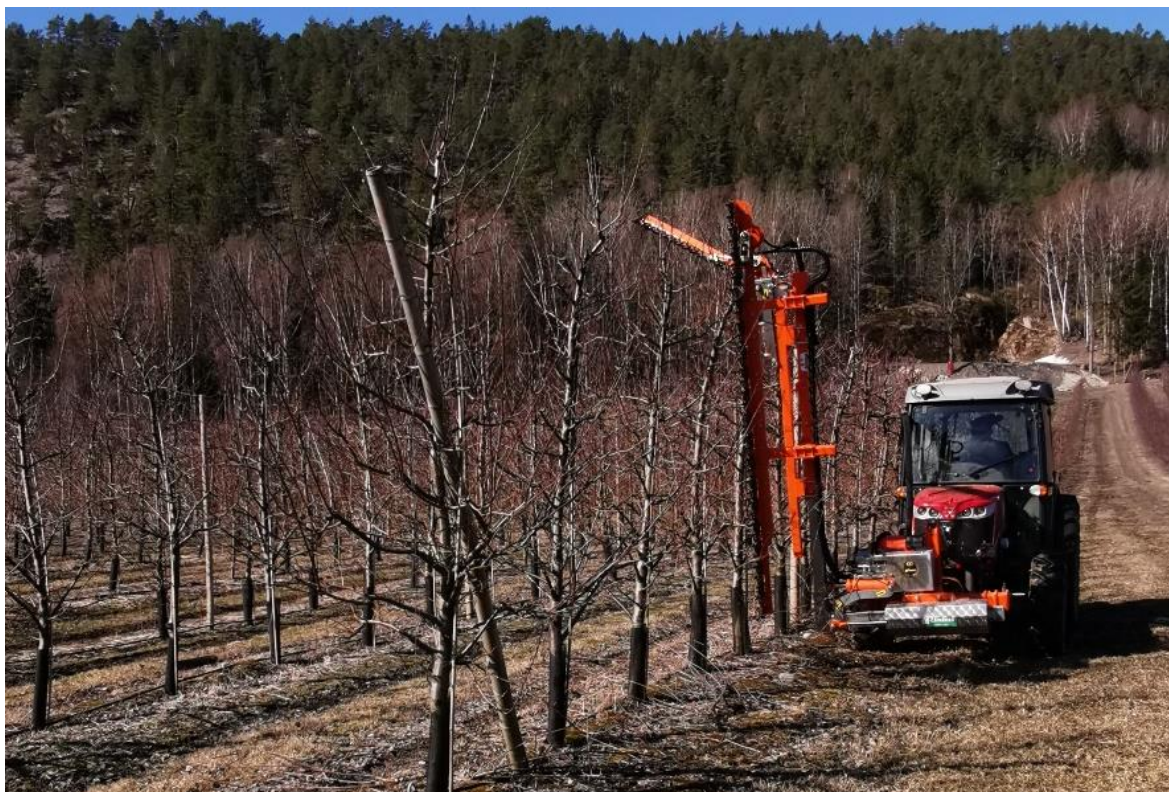
Figur 6. Beskjæring av plommetre med Rineri fingerbjelke montert på fronthydraulikk på traktor. Denne modellen har eigen bjelke for å ta toppen av hekken. Denne maskinen fungerer godt på årleg beskjæring av lehekk. Foto: Gaute Myren, NLR Viken.
